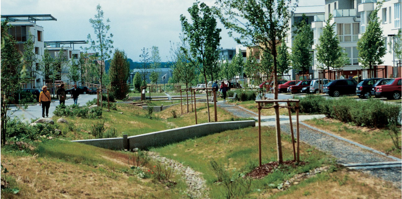
De inrichting van de woonstraten kan een belangrijke rol spelen voor de vertraagde waterafvoer en het versterken van het groen-blauwe netwerk. Referentie: Kronsberg, Hannover, Duitsland.
